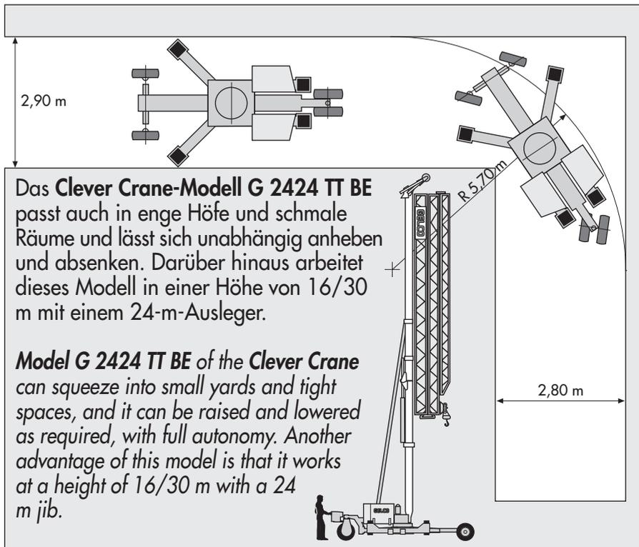
Das **Clever Crane-Modell G 2424 TT BE** passt auch in enge Höfe und schmale Räume und lässt sich unabhängig anheben und absenken. Darüber hinaus arbeitet dieses Modell in einer Höhe von 16/30 m mit einem 24-m-Ausleger.
